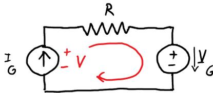
$I_G = 1A$  a)  $V = V_R + V_G = I_G \cdot R + V_G = 20V$
