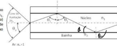
longo da fibra pelo fenómeno de reflexão interna total. O chamado cone de aceitação de uma fibra ótica é definido pelo ângulo máximo de incidência de um raio luminoso proveniente no exterior (de índice de refração  $n_0$ ) que se propaga para o interior da fibra nas condições de reflexão interna total. Este ângulo é definido entre o eixo longitudinal da fibra e o raio incidente (ver figura).
