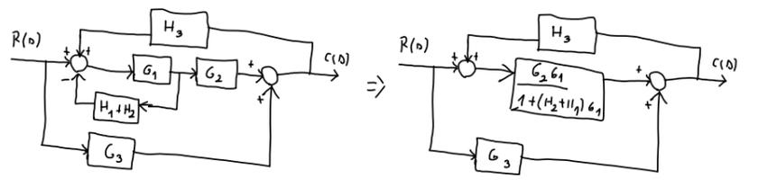
$\left( \frac{G_2 G_1}{1 + (H_2 + H_1) G_1} + G_3 \right) \cdot \left( \frac{1}{1 - \frac{G_2 G_1 H_3}{1 + (H_2 + H_1) G_1}} \right) = \frac{G_3 + G_1 G_2 + G_1 G_3 (H_1 + H_2)}{1 + G_1 (H_1 + H_2)} \cdot \frac{1 + (H_1 + H_2) G_1}{1 + (H_1 + H_2) G_1 - G_2 G_1 H_3}$
